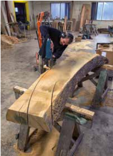
Bomen die van jongs af aan gedwongen krom groeien leveren bruikbaar hout voor kromme delen van bijvoorbeeld schepen of molens.
